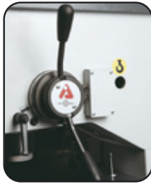
Filettatura mediante teleinvertitore a 24 V; - filetage moyennant téléinverseur à 24 V; - threading by 24V teleinverter.
