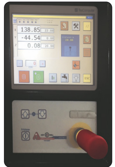
CNC TOUCH DA 8" con visualizzazione dei tre assi Z (discesa canotto), X, Y - CNC touch de 8" avec visualisation des 3 axes Z (descente du canot), X, Y - 8" CNC touch with 3 axes display Z (lavinger spindle), X, Y
